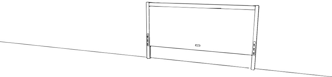
2. Bettseiten einhängen und Mittelsteg positionieren.
